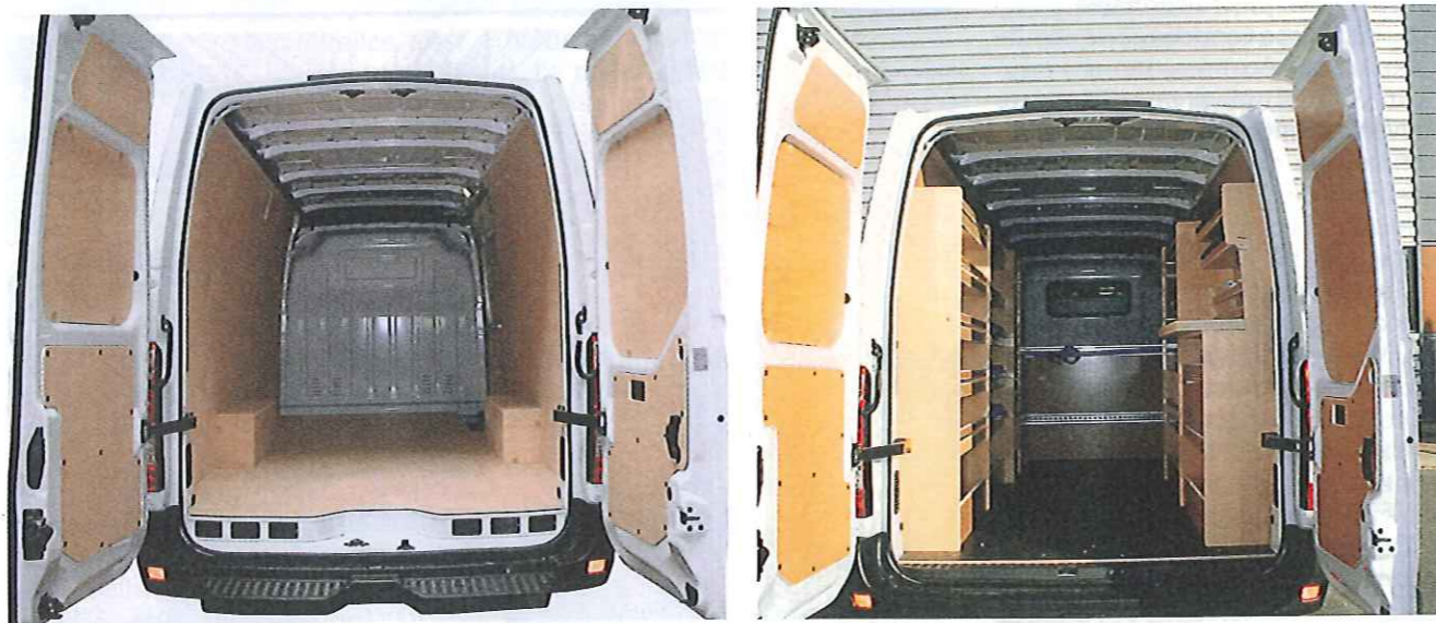
MDP revêt les parois, les portes et le plancher du véhicule d'un habillage de bois découpé et posé par ses soins avant d'y aménager ses racks de rangement.
